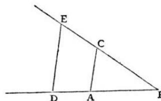
Soit par exemple AB l'vnité, & qu'il faille multiplier BD par BC, ie n'ay qu'a ioindre les points A & C, puis tirer DE parallele a CA, & BE est le produit de cete Multiplication.
